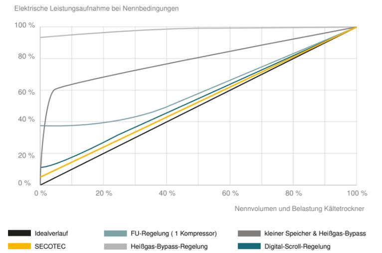
die Druckluft auch während der Anlaufphasen wirksam getrocknet. Die hochwertige Isolierung des Speichers ermöglicht auch dabei einen minimalen Energieeinsatz. Zudem erfolgt die Drucklufttrocknung mit SECOTEC Kältetrocknern nicht nur sehr energieeffizient, sondern dank der hohen Speicherkapazität in besonders schonender Betriebsweise.
