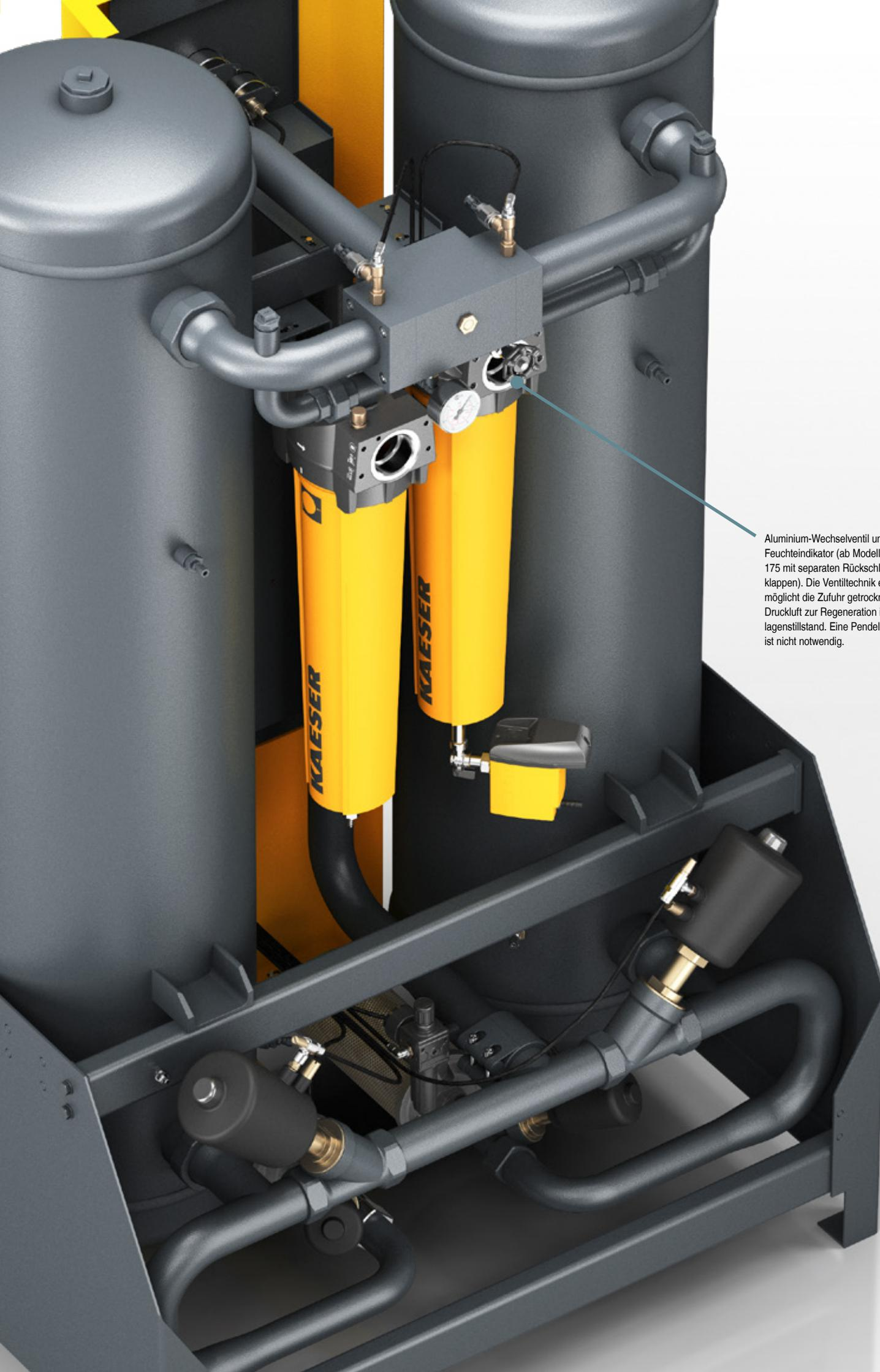
Aluminium-Wechselventil und Feuchteindikator (ab Modell i.DC 175 mit separaten Rückschlagklappen). Die Ventiltechnik ermöglicht die Zufuhr getrockneter Druckluft zur Regeneration im Anlagenstillstand. Eine Pendelleitung ist nicht notwendig.
