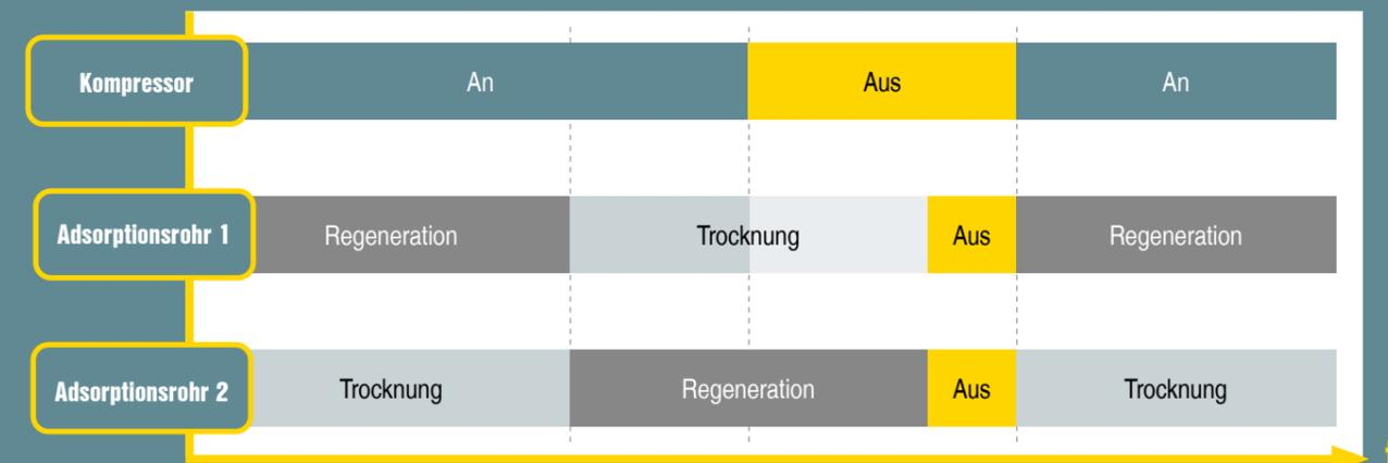
Bei anliegendem Fern-Aus-Signal wird die aktuell laufende Regenerationsphase vollständig komplettiert. Erst dann endet der Halbzyklus. Dazu wird getrocknete Druckluft benötigt. Bei wiederkehrendem Fern-Ein-Signal startet der nächste Halbzyklus.
