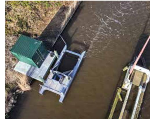
*Bild oben: Die Bubble Barrier und das Auffangsystem von oben.*
