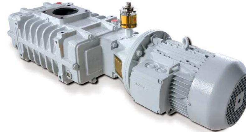
Pour la production du vide poussé en liaison avec une pompe de pré-vide appropriée, le WCV augmente la capacité d'aspiration et le vide de la pompe de pré-vide. L'utilisation d'un convertisseur de fréquence est particulièrement recommandée car elle permet la mise en circuit simultanée de la pompe à vide à pistons rotatifs et de la pompe de pré-vide à la pression atmosphérique, ce qui réduit considérablement le temps de pompage.
