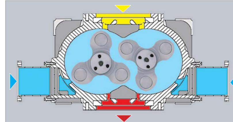
Lorsque le vide (en jaune) est emprisonné entre le rotor et le carter, les rotors, en poursuivant leur rotation, font entrer de l'air atmosphérique (en bleu) dans le bloc surpresseur par les chambres de préadmission. Les flux d'air sous vide et d'air atmosphérique se mélangent et la chaleur engendrée par la compression se répartit sur une masse d'air emprisonnée beaucoup plus importante. Il est ainsi possible d'obtenir les mêmes températures de refoulement qu'avec les blocs surpresseurs normaux.
