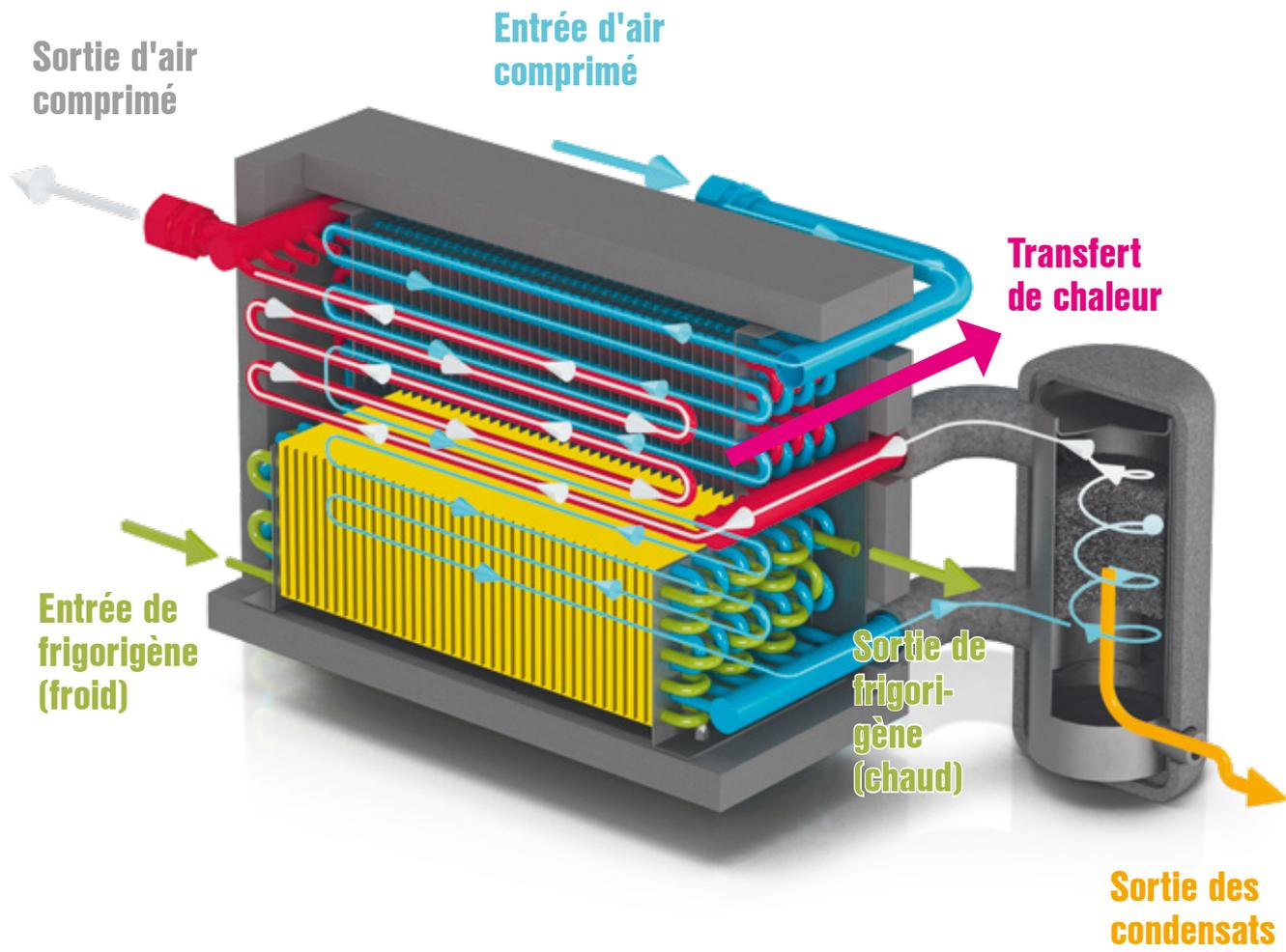
Accumulateur frigorifique SECOTEC à masse thermique sèche
